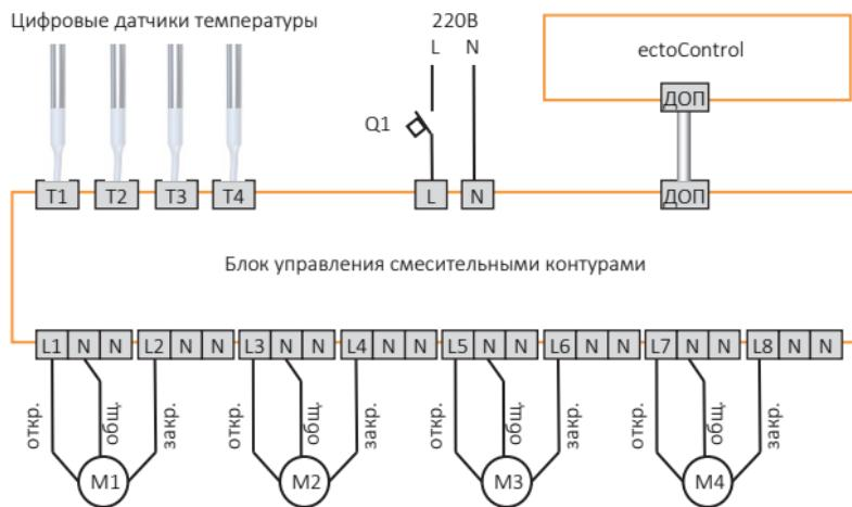
В порты T1...T4 подключаются цифровые датчики температуры ectoControl.
