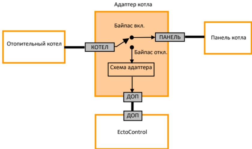
По умолчанию режим «Байпас» отключен, котел подключен к схеме адаптера, а внешняя панель не подключена ни к чему. Адаптер может управлять котлом по цифровойшине.
