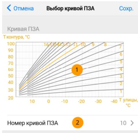
1 Семейство кривых, преобразующих значение уличной температуры в температуру в контуре. Чем выше номер кривой, тем более высокая температура будет поддерживаться в контуре.
